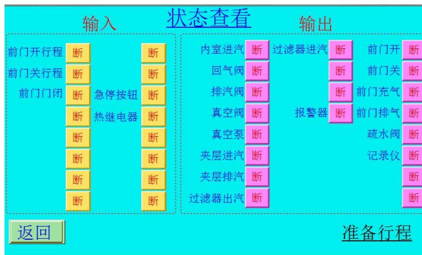
显示输入输出**通断**状态，按动**返回**键，则返回目前行程。
